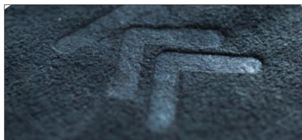
[ E ] **EMBOSSING** – Bezeichnet eine dreidimensionale Drucktechnik. Mit dieser Drucktechnik erreicht man eine sehr hochwertige Optik. Diese Methode kann auf allen Materialien verwendet werden, die Hauptverwendung findet sie aber auf Baumwolle, Polyester und Fleece.
